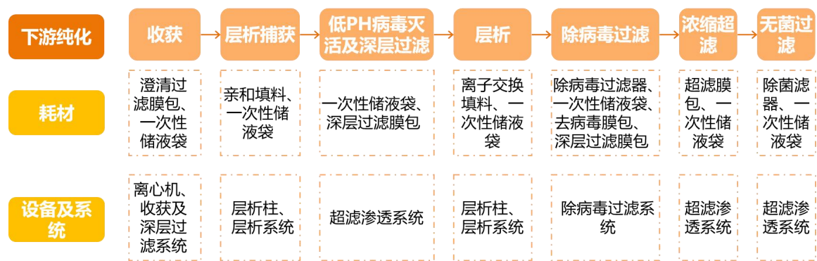
生物药分离纯化流程示意图
