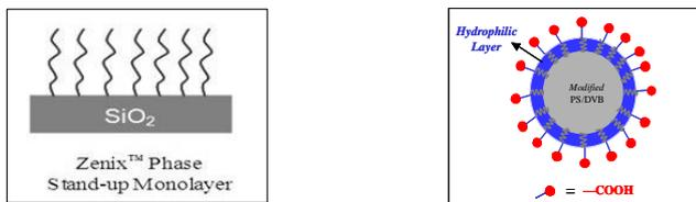
图 1. Zenix™ SEC-300 和 Antibodix™ WCX 的固定相表面结构
